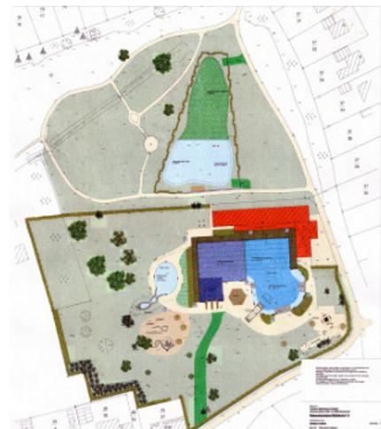
Der Reinigungsprozess funktioniert im Kreislaufprinzip und basiert auf dem biologischen Gleichgewicht, wie es in naturbelassenen Gewässern vorherrscht. Das abgedaute Badewasser wird unter erhöhter Sauerstoffzufuhr, welche auch der Algenbildung vorbeugt, durch einen mehrschichtigen Kiesfilter im Regenerationsteich gereinigt. Dieser wurde in dem an das Freibadgelände angrenzenden Park errichtet.
